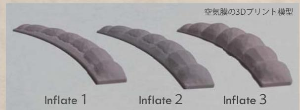
皮膜となる空気膜には、ETFE(フッ素樹脂膜)を用い、ETFEは熱を吸収し光を透過する。また、膜を2層、3層とすることで、熱貫流率( $1.7\sim2.6\text{W/mK}$ )や透過率(75.4~82.4%)をコントロールし、内部空間を快適にすることができる。
